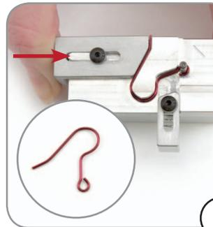
Poussez le gros piston afin d'obtenir la forme d'un crochet de boucle d'oreille. Pour plus de facilité, pousser le petit piston afin de bien tenir le crochet en place. Coupez l'excédent de fil si nécessaire. Pour rendre vos crochets plus confortables à porter, utilisez l'outil à ébarber pour arrondir le bout pointu du fil métallique.
